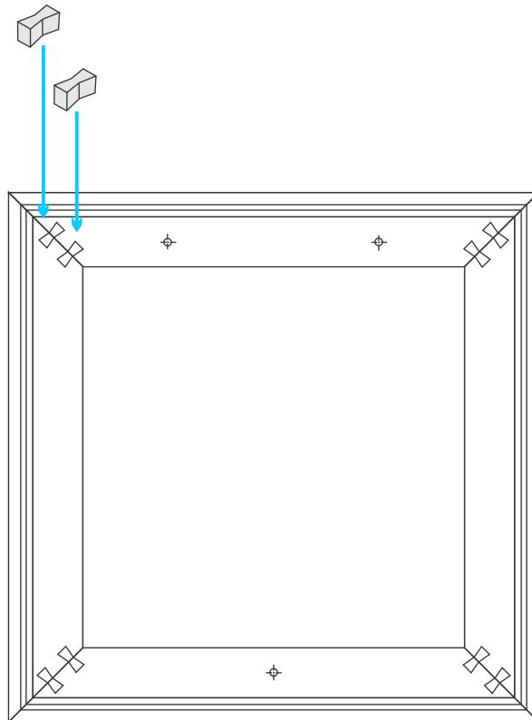
2. Закрепите рамку на стене с помощью шурупов. Шурупы вкручивайте в существующие отверстия на раме.
