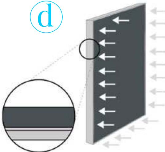
Продолжайте вставлять силиконовую ленту равномерно по всему периметру рамы, не позволяя появляться бугоркам. В самом конце, аккуратно, с небольшим усилием, прижмите силиконовую ленту по всему периметру рамы.
