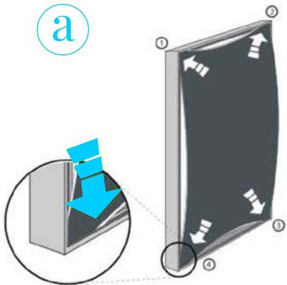
Закрепите изображение в четырех углах, вставив силиконовую ленту в канавку
